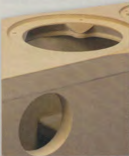
Die Aufweitung des Tieftöner-Ausschnitts spart Stützpunkte für die Schrauben aus; hier setzt BD Audio-Engineering Gewindehülsen mit M4- bzw. M5-Gewinde ein – eine durchdachte Lösung.
