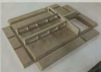
Die Innenstruktur des Gehäuses fertigt Dörfler unter Nutzung der Möglichkeiten des CNC-Fräseautomaten aufwändiger, als der Gehäuseplan auf Seite 46 es vorsieht.
