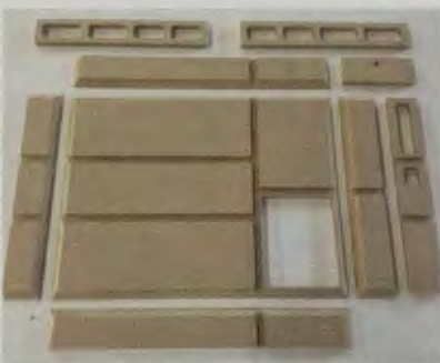
Rück- und Seitenwände sind mit Nuten für die Aufnahme des Innenlebens, Frequenzweichenfach und Verstrebungen, versehen. Die außen sichtbaren Materialübergänge sind auf Gehrung gearbeitet.
