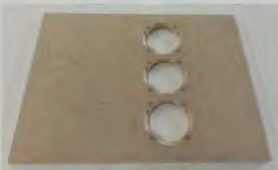
Auf der Innenseite der Gehäusefront sind die Chassis-Ausschnitte großzügig aufgeweitet. Davon ausgenommen sind je vier Stützpunkte, an denen die Gewindehülsen für die Befestigung der drei Breitbänder eingesetzt werden.
