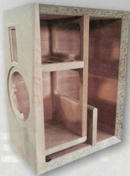
Schnittmodell: Ohne die zweite Seitenwand ist der innere Aufbau erkennbar. Beim senkrechten Gehäuseteiler ist der untere Ausschnitt noch zu klein; dieser müsste in gleicher Höhe wie der Bassreflexleiter dahinter enden.
