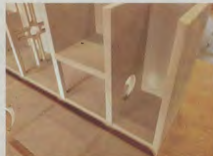
Die Rückwand des Mitteltongehäuses ist in die angrenzenden Teiler eingenutet.
