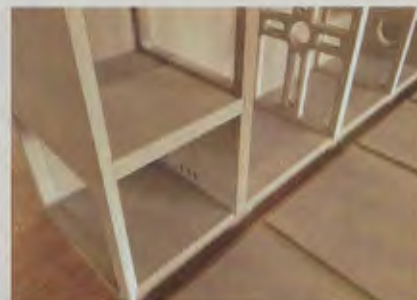
Der Gehäuseboden erstreckt sich über die volle Gehäusetiefe. Das Frequenzweichenfach ist über einen Ausschnitt zugänglich.
