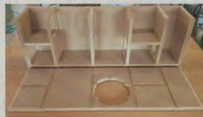
Ohne Front und mit aufgeklappter zweiter Seitenwand zeigt sich der Innen-Aufbau des Gehäuses: Nuten, die das Gehäuse-Innenleben präzise fixieren, sowie die gefräste „Blume“ auch am Ausschnitt für den Tieftöner.
