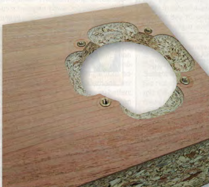
Rückseite aus Kirschbaum-furnierter Spanplatte mit Ausfräsung für den Ambient-Breitbänder: Auf der Gehäuse-Innenseite ist dieser Ausschnitt großzügig aufgeweitet. Davon ausgenommen sind vier Stützpunkte, an denen die Gewindehülsen für die Befestigung der drei Breitbänder eingesetzt werden.
