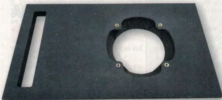
Frontplatte aus schwarzem MDF mit Ausfräsung für den Front-Breitbänder; als Gewinde-Einsätze verwendet Bernd Dörfler „Serfix“-Buchsen aus Messing mit M4-Gewinde.
